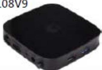
1个音频光纤，1个AV口，1个HDMI口，1个网口,2个USB,1个SD卡接口-FLASH 8
